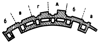
Рис. 165. Компонка аэровокзала аэропорта Даллас-Форт-Уерт из мелких объемно-конструктивных единиц "роста". Система развития: 1-3 - типы блоков; а-д - варианты компоновки блоков. Схематичный план сектора аэровокзала. Фрагмент общего вида аэровокзала
